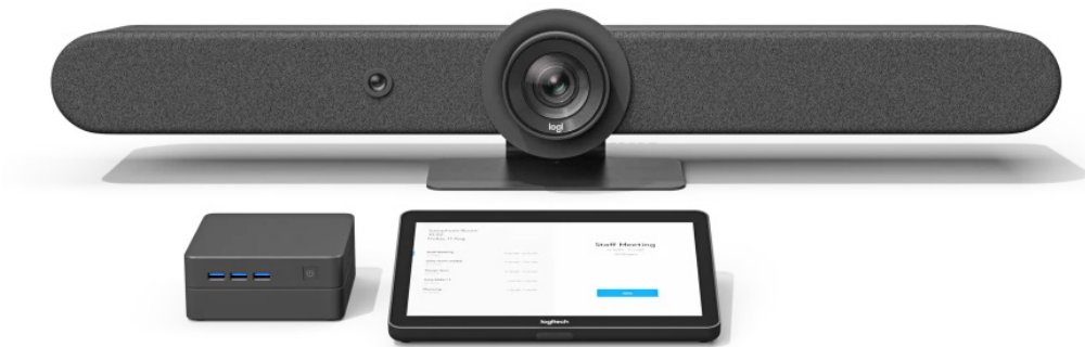
Figura 1: Logitech Rally Bar (grafite) - Exibida com PC e o controlador por toque Logitech Tap opcionais
