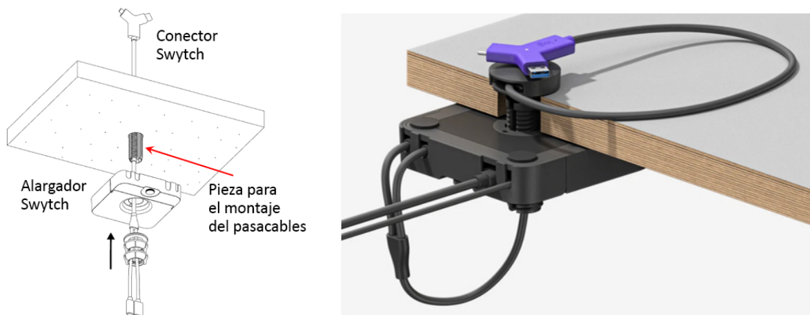
Figura 8: extensor Logitech Swytch, montaje de ojal bajo la mesa
