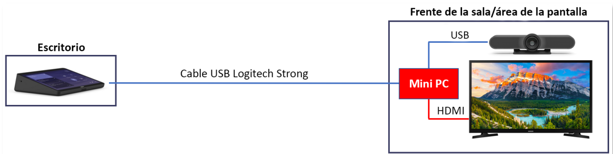
Figura 4: diagrama de instalación de la solución de Logitech para salas pequeñas, incluidos Logitech Tap y MeetUp
