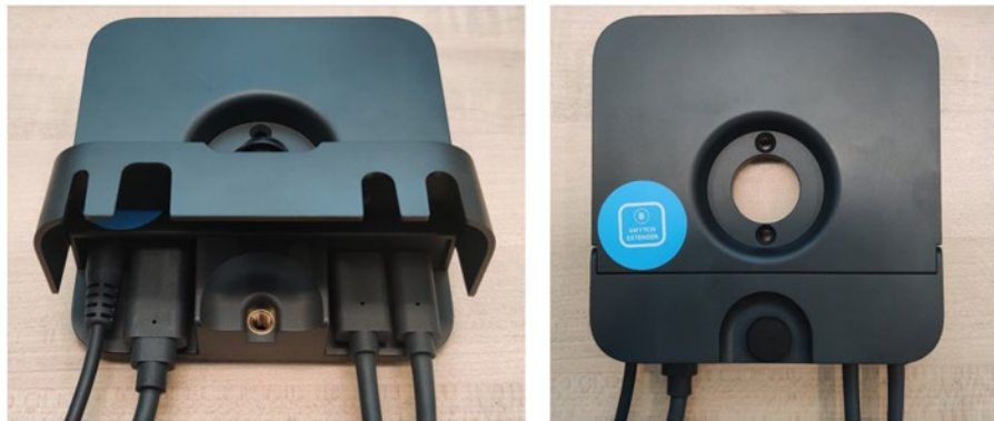
Abbildung 7: Logitech Swytch Extender – versenkter Kabelbereich mit integrierter Zugentlastung für Kabel
