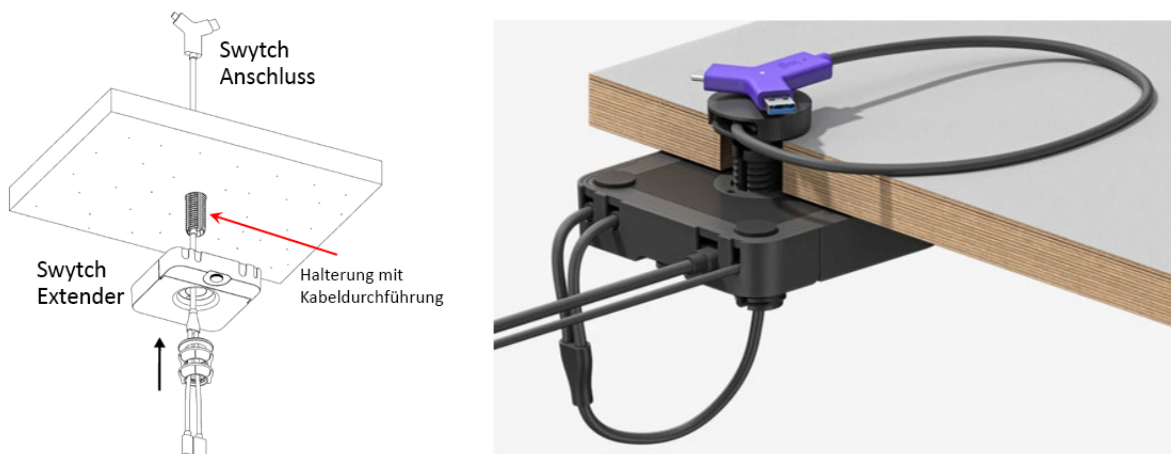
Abbildung 8: Logitech Swytch Extender – Kabeldurchführungsbefestigung unter dem Tisch
