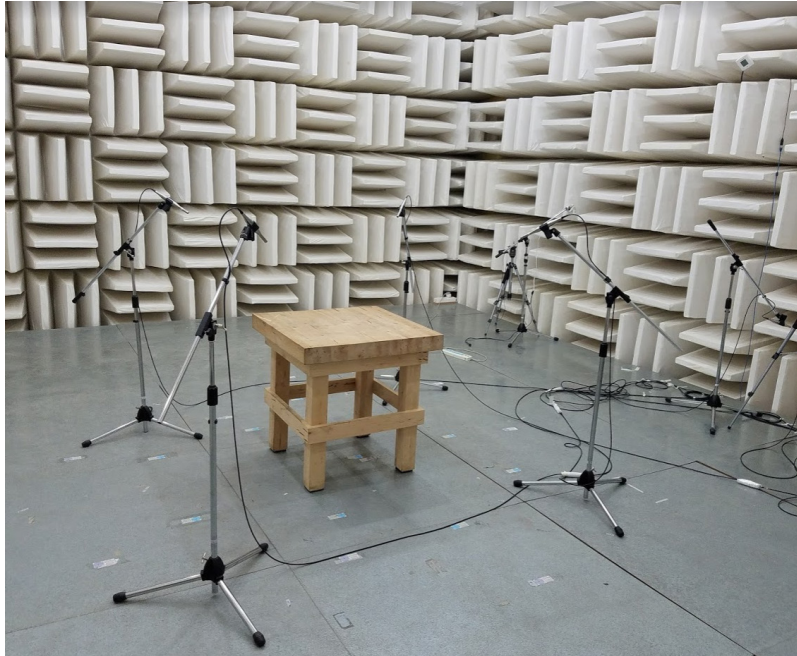
Abbildung 9: Akustiktest-Ausstattung im echofreien Raum bei Foxconn CMC mit < 6 dBA Hintergrundgeräusch
