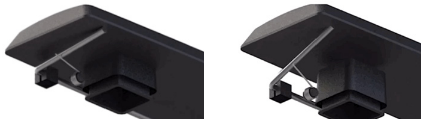
Abbildung 4: Das Torsionsfederstrukturdesign reduziert Lärm, indem die Gleichgewichtsvorkehrung und die Tastenkappe dicht zusammengehalten werden
